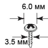
ПРИМЕЧАНИЕ: Перед ввинчиванием болтов убедитесь, что диаметр головок и стержней болтов подходит к отверстиям крепежного устройства.
