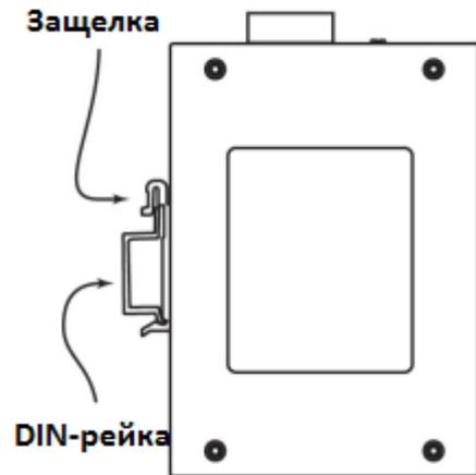
Чтобы снять коммутатор с DIN-рейки, повторите шаги в обратном порядке.
